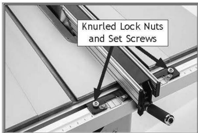
Рисунок 112. Расположение винтов регулировки наклона параллельного упора.
